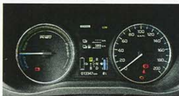
Namísto otáčkoměru je tady energetický ukazatel. To je u hybridů obvyklé.
