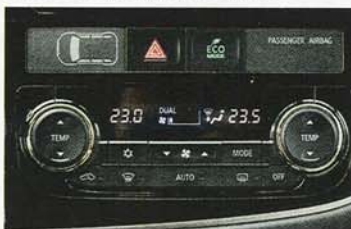
Klimatizace pracuje s elektrickým kompresorem. Jinak by v režimu EV nechládila.
