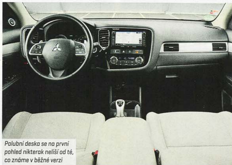
Namísto otáčkoměru je tady energetický ukazatel. To je u hybridů obvyklé.
