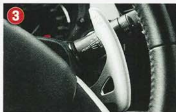
1 V motorovém prostoru zaujme vprava jednotka střídače-měniče. V předí je ukryta celkem pět chladičů. 2 Tohle není volič samočinné převodovky, nýbrž pouze jízdy jako takové. 3 Páčkami pod volantem se nastavuje úroveň rekuperace v šesti krocích.
