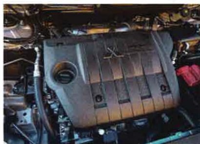
Dieselu typu 4N14 stačí k plnění Euro 6b jednodušší, bezúdržbový zásobníkový katalyzátor „denox“
