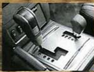
Čtyřkolku Super Select tradičně ovládá jediný volič, výjimkou je závěr zadního diferenciálu
