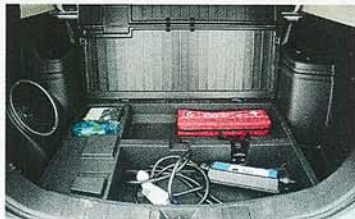
Baterie se kompletně vešla pod podlahu, vnitřní prostor nebyl ovlivněn. Pode dnem se skrývá nabíjecí kabel.
