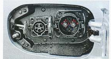
Pod samostatným krytem se skrývají konektory do klasické zásuvky (vlevo), vpravo je rychlonabíjecí zdířka Menekes. Dole je víko zmenšené nádrže.
