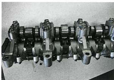
▲ Mechanismus rozvodu s jedním vačkovým hřídelem a soustavou vahadel.
