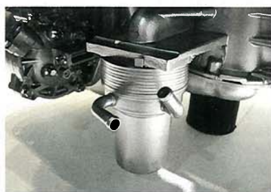
▲ Podobně jako u motorů VW je i zde přítomen chladič oleje „olej/voda“.
