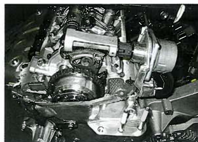
▲ Plynule proměnný zdvih ventilů je ovládán elektromotorem přes šnekový převod.
