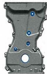
Kryt rozvodů původního motoru.
