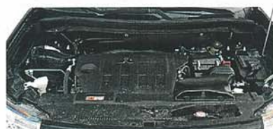
▲ Downsizing se nekoná. 2,2 litru a 110 kW. Sání je vyvedeno hodně vysoko.
